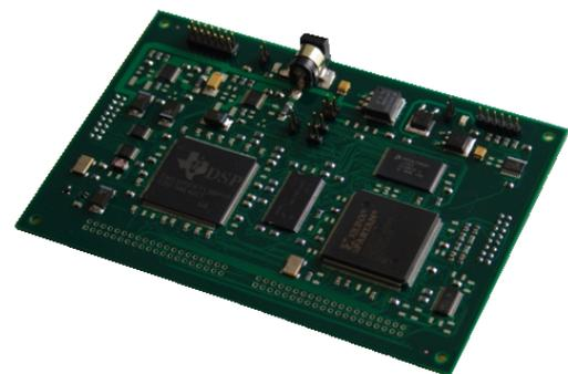
Рис. 10. Модуль цифровой обработки сигналов с реконфигурируемой логикой
